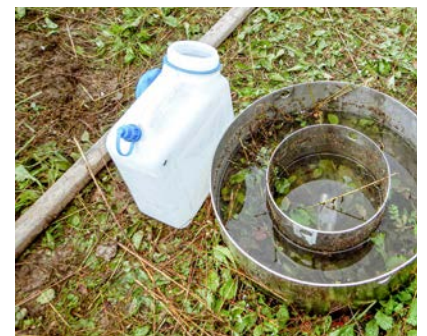
Doppelring-Infiltrometer Quelle: Jäckli Geologie AG
